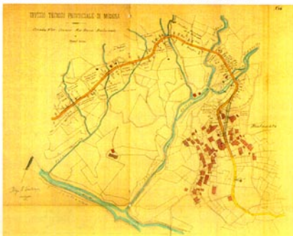
fig. 12 - "Strada n. 40: tronco Riobeco Riolunato", planimetria generale, s. d.[1934], scala 1:2000, originale su carta, inchiostro monocromo e acquarello policromo, 360x500 (APMO, UT, Strade , b. n. provv. 250/C/11, progetto di correzione di curva nella traversa di Riolunato).
