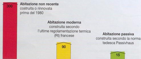
**Emissioni di CO<sub>2</sub>** in rapporto all'energia usata per il riscaldamento e l'acqua calda in un'abitazione di 100 m<sup>2</sup> kg equivalente carbone, all'anno
