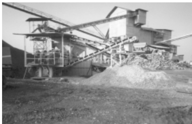
Figura 3. Vaglio vibrante a superficie piana con nastro di carico per la frazione più grossolana.
