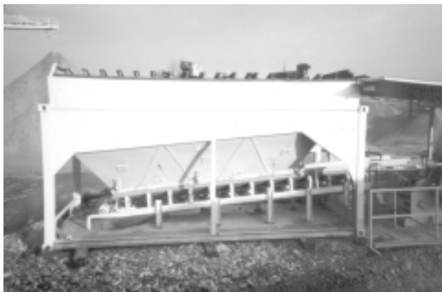
Figura 2. Frantoio a mascelle di tipo mobile, all'uscita del quale è presente un nastro di carico che conduce ad un vaglio vibrante.
