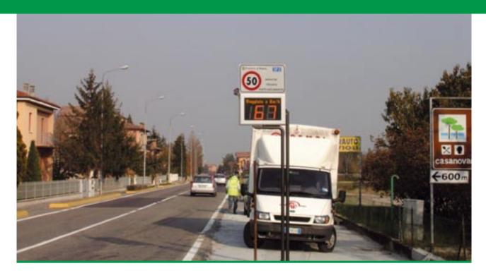
Si tratta di un apparecchio misuratore di velocità con display, dotato di sensore radar per il controllo della velocità e per la rilevazione dei dati di transito.
