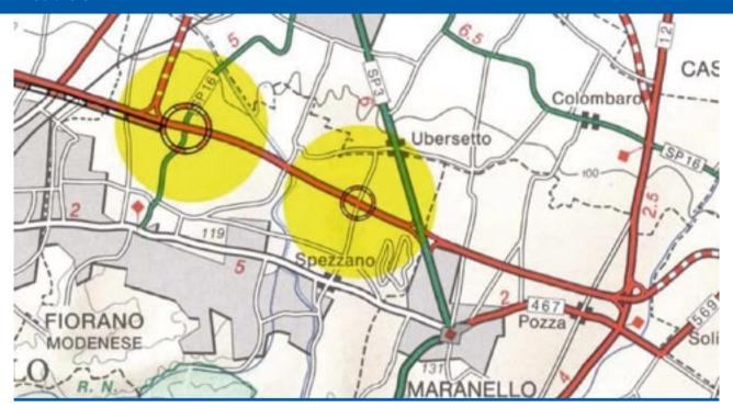
L'intervento consiste nella realizzazione di svincolamenti a livelli sfalsati in corrispondenza delle intersezioni con via Canaletto e via Ghiarola Vecchia sulla Pedemontana, attualmente semaforizzati. Ad ognuna delle testate delle rampe di accesso dei cavalcavia che scavalcheranno la SP 467 la connessione con al viabilità locale avverrà tramite rotatorie, in modo da eliminare completamente le svolte a sinistra.
