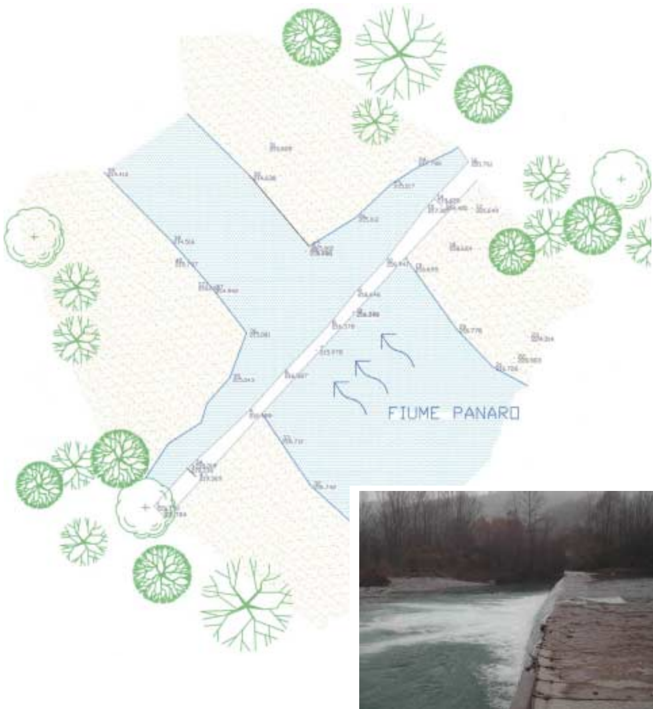
Figura 49 Rilievo piano-altimetrico dello sbarramento di Ponte Samone (rilievo eseguito da Provincia di Modena - Servizio Lavori Speciali Strade)
