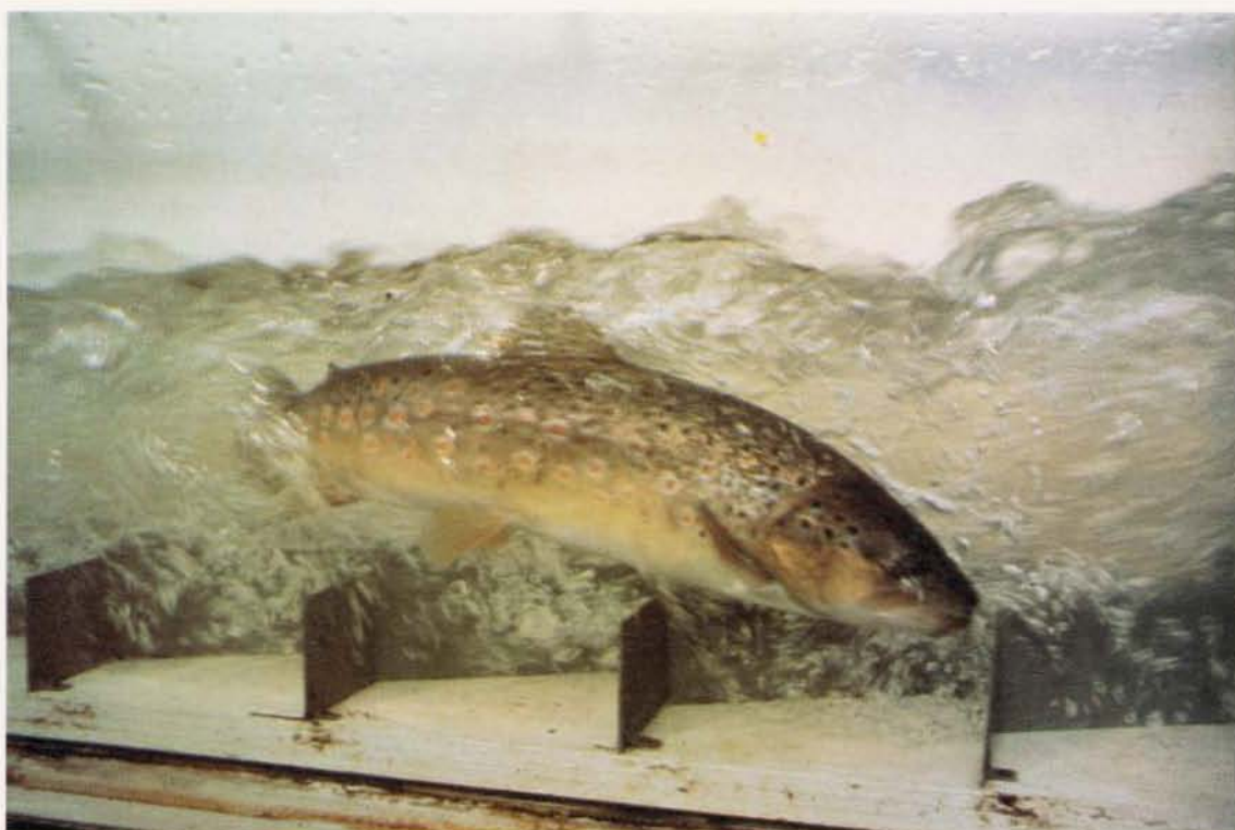
15 - Trota fario che risale un modello con dissipatori sul fondo.
