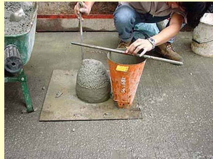
misura dello slump
