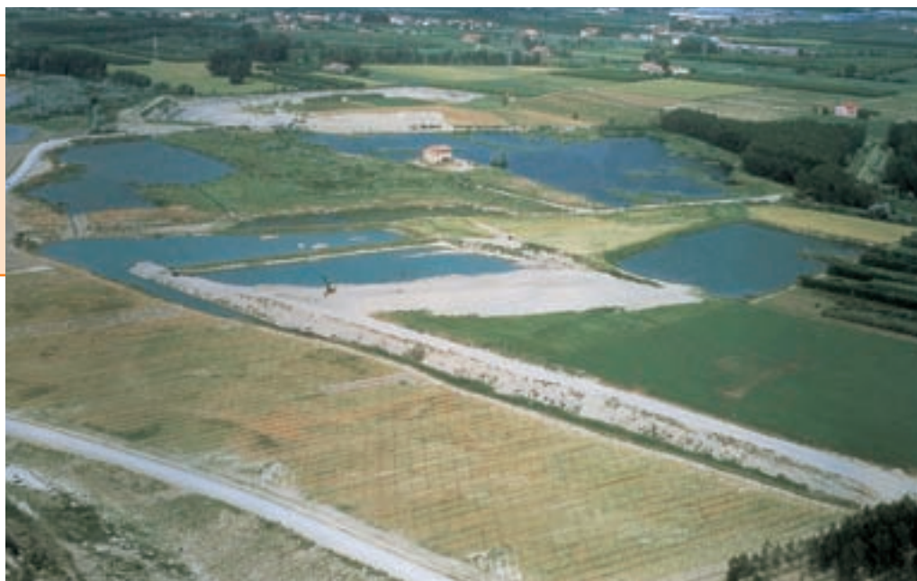
CASSA DI ESPANSIONE DEL PANARO (S. CESARIO) - La foto risale ai primissimi anni '80; l'area fotografata è collocata in riva destra del fiume Panaro, nel comune di S. Cesario. Le aree di cava interessate da estrazione storica negli anni '60 sono state recuperate a lago vista la presenza di acqua a causa della falda di subalveo.
