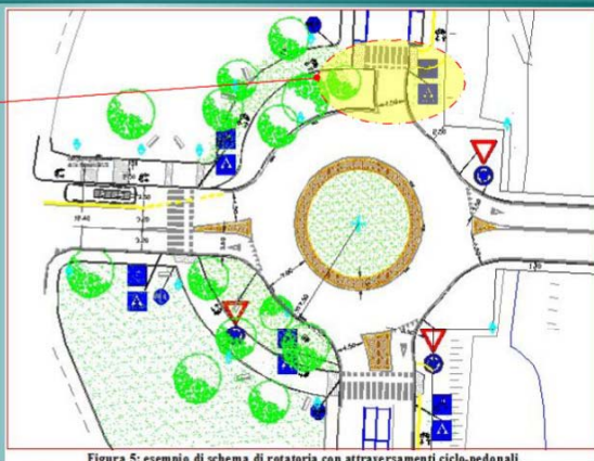
Figura 5: esempio di schema di rotatoria con attraversamenti ciclo-pedonali
